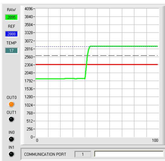
Wird der aktuelle Messwert **RAW** (grüne Linie) wieder größer als die Hystereseschwelle (schwarze Linie), dann wird auch der Ausgang **OUT0** wieder +24V (Signal ist in Ordnung). Dies wird über die LED **OUT0** visualisiert.
