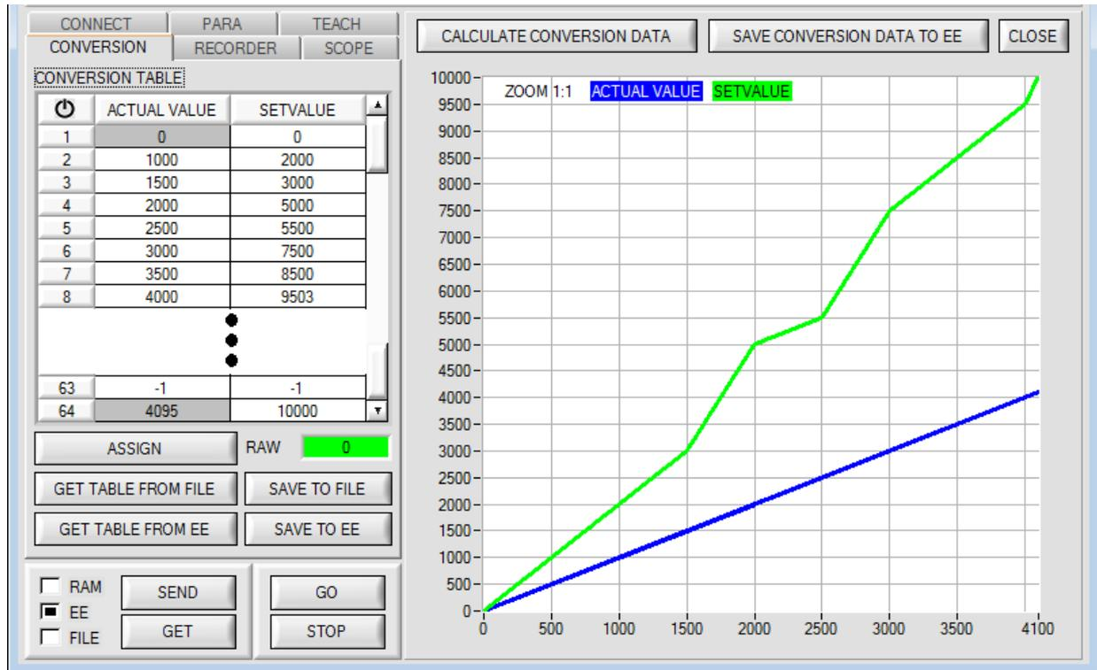
Durch Drücken von **GO** wird der aktuelle **RAW** Werte im Display **RAW** angezeigt.
